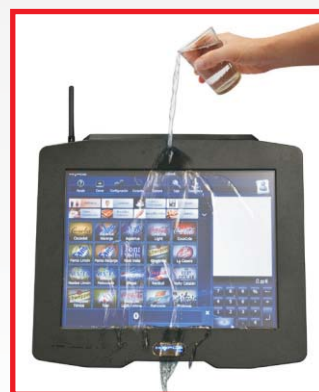
Test de resistencia al agua IP66
